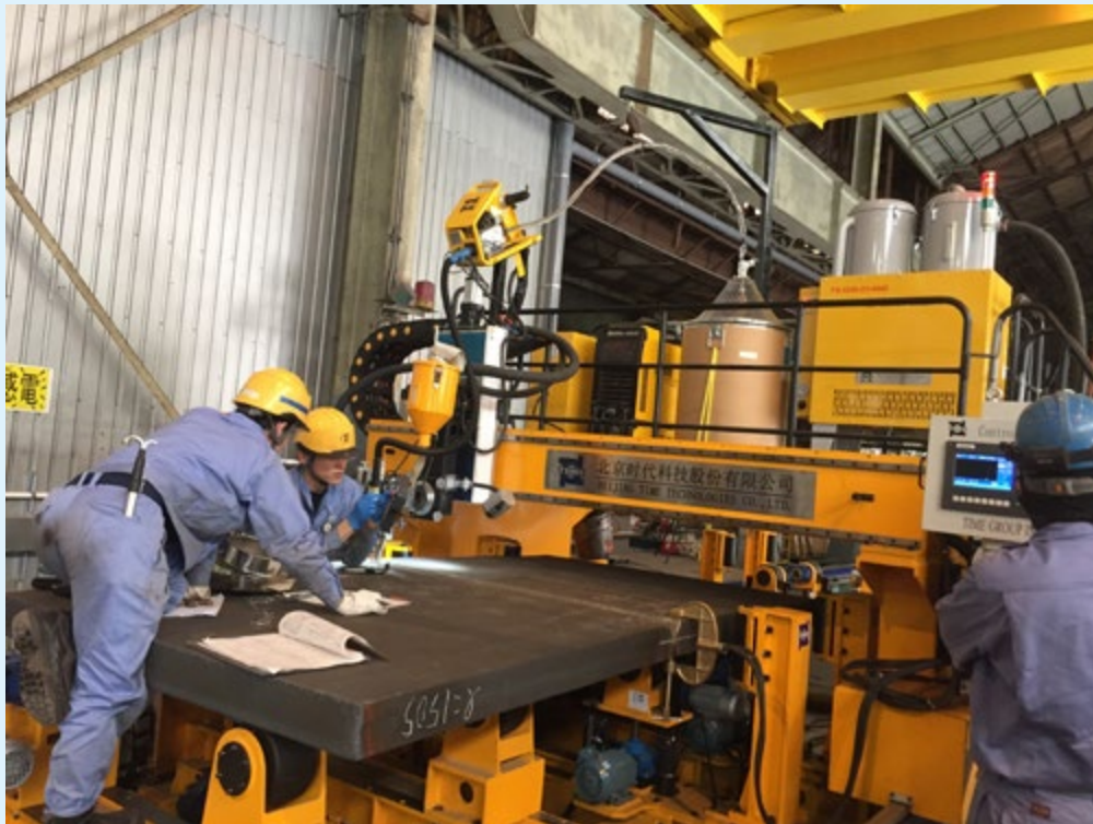
超高熔敷率厚壁不锈钢窄间隙拼板焊（出口日本）
