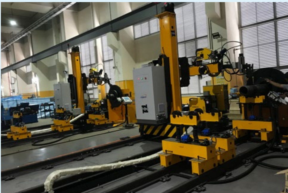
配置三种工艺的智能管道焊接专机
