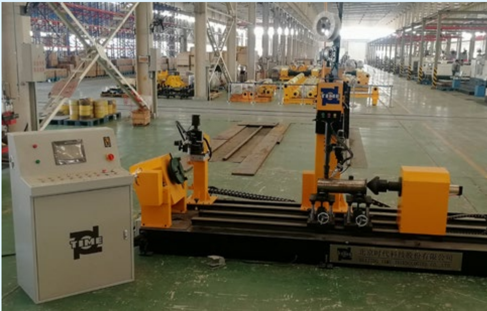
卧式纵缝、立式环缝、小马鞍焊接一体机
